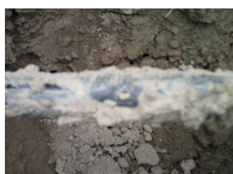
شکل ۲- گرفتگی قطره چکان ها در اثر نفوذ ریشه و خاک به داخل آن ها
