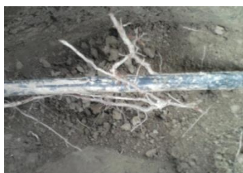
شکل ۲- گرفتگی قطره چکان ها در اثر نفوذ ریشه و خاک به داخل آن ها
