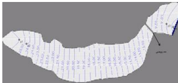
شکل 6 - نقشه هم پتانسیل سطح آب زیرزمینی بعد احداث سد
