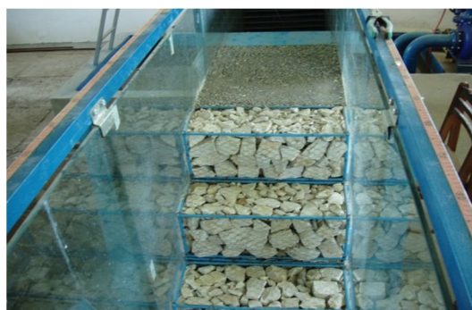
شکل 7- مدل سرریز پلکانی گابیونی با رسوب در بالادست
