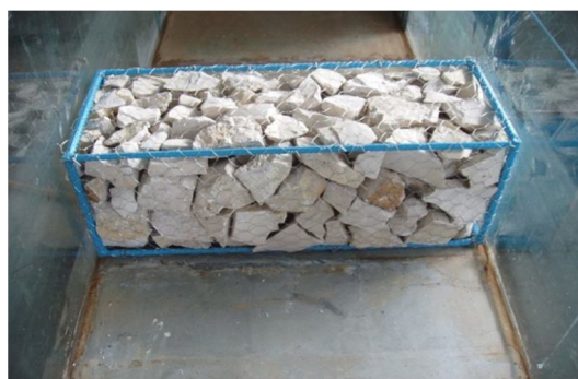
شکل 6- مدل سرریز پلکانی گابیونی بدون رسوب
