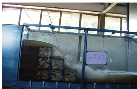
شکل 10- نمونه آزمایش بر روی مدل سرریز پلکانی گابیونی با رسوب
