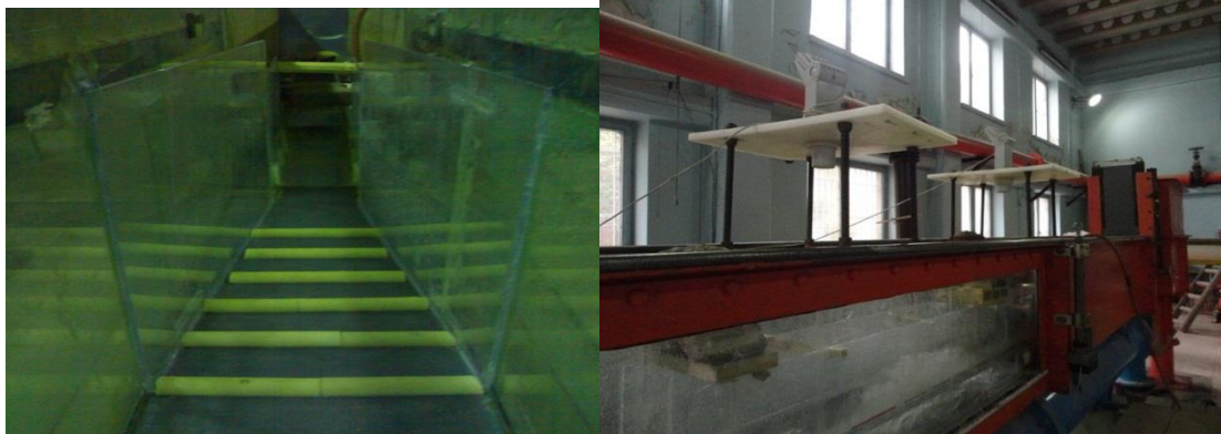
شکل ۱- نمایش فلوم آزمایشگاهی و بستر زیر نیم‌استوانه‌ای
