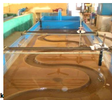
شکل ۳- جزئیات کانال ماریچی آزمایشگاهی با تجهیزات اندازه‌گیری، (Khatua et al., 2011)
