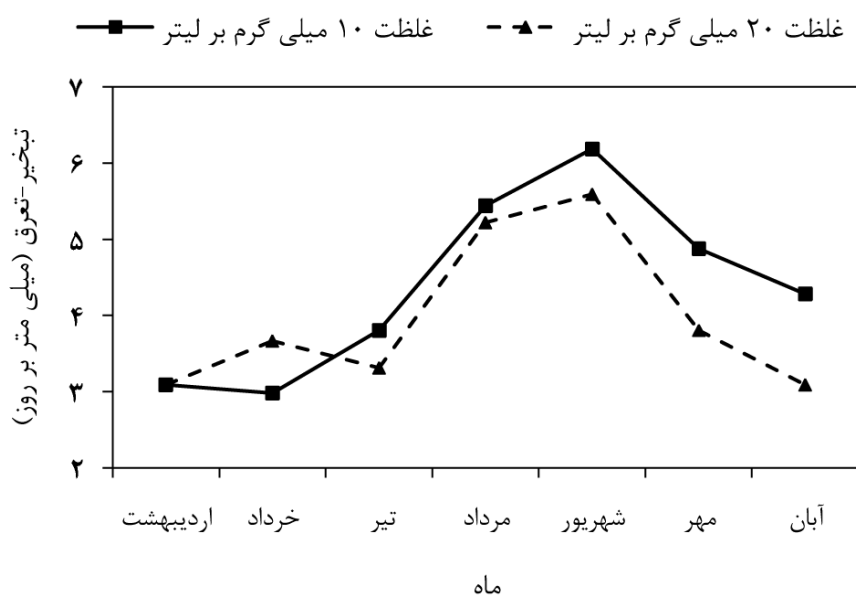
شکل 6- نمودار تغییرات تبخیر-تعرق گیاه تیفا نسبت به زمان در تیمار غلظت 10 و 20 میلی گرم بر لیتر
