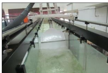
شکل ۳- وسیله ساخته شده جهت ایجاد جت آبی و ابعاد آن
