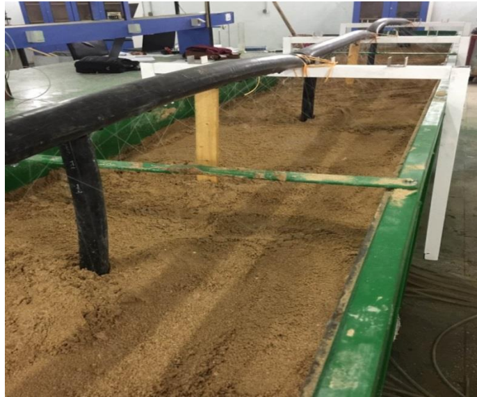
شکل ۵- نمایی از لوله‌های مخصوص بارش سطحی
