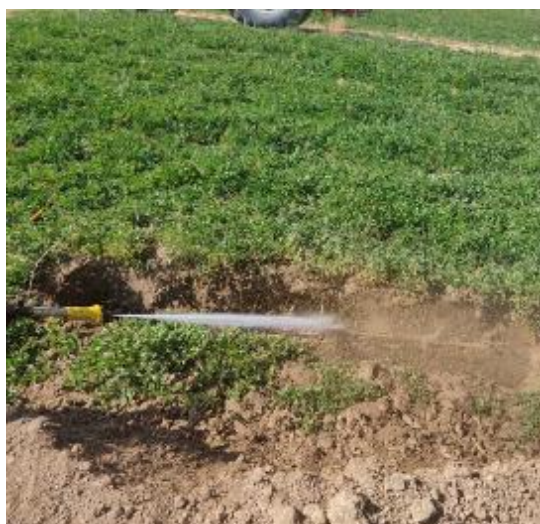
شکل ۲- حفر ترانشه و شستشوی خاک اطراف لوله‌ها، جهت بررسی گرفتگی قطره‌چکان‌ها (پایان سال سوم)
