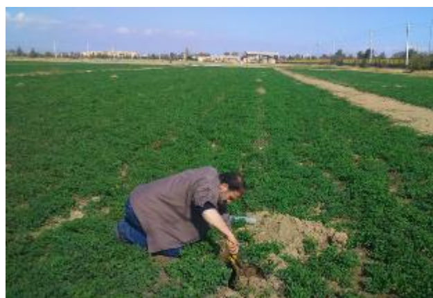
شکل ۱- اندازه‌گیری دبی قطره‌چکان‌ها در آبیاری قطره‌ای زیرسطحی
