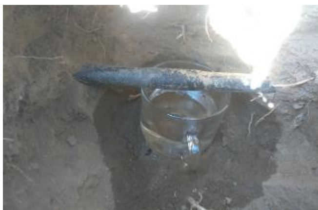
شکل ۱- اندازه‌گیری دبی قطره‌چکان‌ها در آبیاری قطره‌ای زیرسطحی
