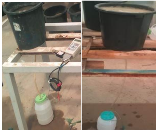
شکل ۱- نمای شماتیکی گلدان در آزمایشگاه و استفاده از Wet sensor برای اندازه‌گیری رطوبت خاک و اندازه‌گیری حجم زه‌آب توسط ظرف درب‌دار
