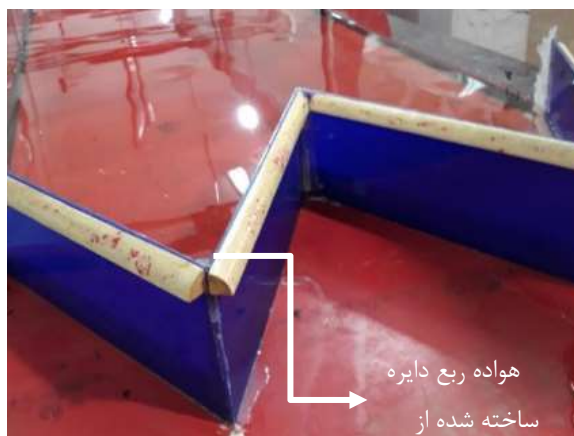
شکل ۴- سرریز کنگره‌ای مثلثی ساده و دارای هواده در L/W = 2
