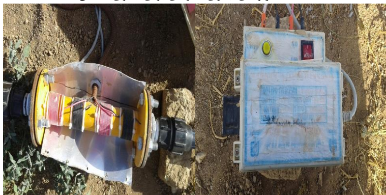
شکل ۳- دستگاه مبدل و سیم لوله استفاده‌شده برای تولید میدان مغناطیسی ثابت.
