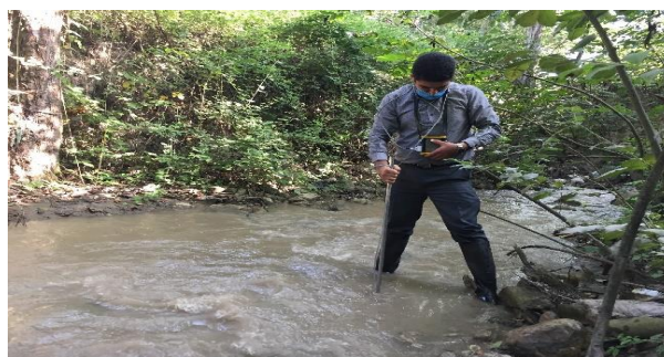
شکل ۲- اندازه گیری جریان با استفاده از میکرو مولینه
