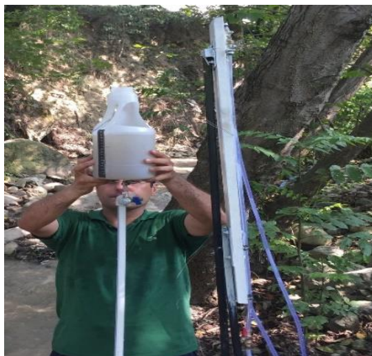
شکل ۹- مخزن به همراه مینی پیزومتر جهت اندازه‌گیری هدایت هیدرولیکی رسوب
