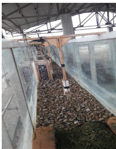
شکل ۲- نمایی از آبشکن‌های متخلخل تعبیه شده
