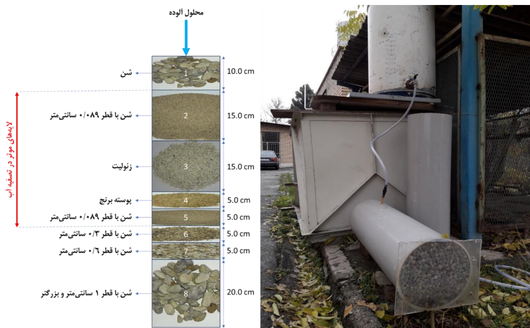
شکل ۱- طرح و جزئیات مواد استفاده شده در مدل فیزیکی ساخته شده در مطالعه
