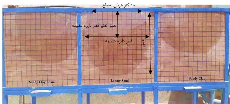
شکل ۲- نمایی از الگوی توزیع رطوبت در مدل آزمایشگاهی و صفات اندازه‌گیری شده
