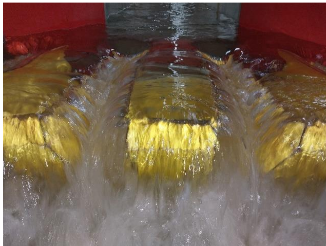
شکل ۷- تداخل جریان در کلیدهای خروجی سرریز کلید پیانویی مستطیلی با شیب ۵ درجه خلاف جهت جریان
