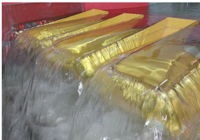
شکل ۲- سرریز کلید پیانویی مستطیلی با شیب ۵ درجه در جهت جریان
