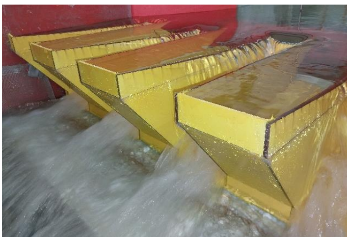
شکل ۳- سرریز کلید پیانویی مستطیلی با شیب ۵ درجه خلاف جهت جریان
