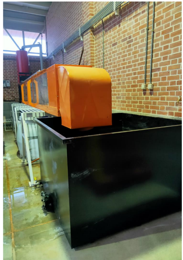
شکل ۱- شماتیک و نمای کلی فلوم تحقیقاتی و بلوک‌های مکعب مستطیلی مورد استفاده در این پژوهش
