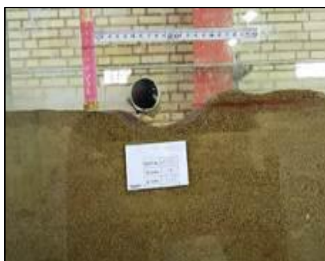
شکل ۳- آبشستگی در زیر لوله با نصب تیغه در انتهای آزمایش (Jabari et al., 2020)
