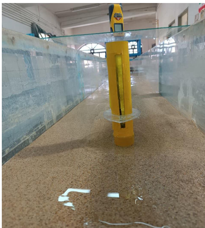
شکل ۱۲- میزان آبستگی اطراف پایه در ترکیب طوق و شکاف
