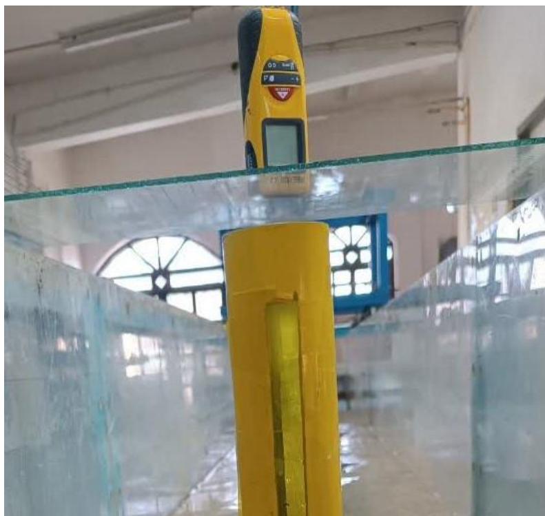
شکل ۶- متر لیزری و شیشه شبکه بندی شده
