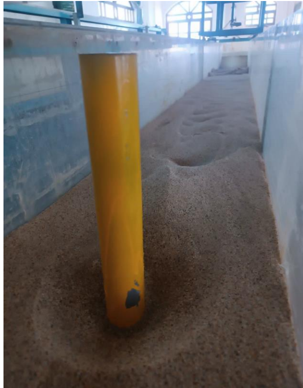
شکل ۱۰- فلوم آزمایشگاهی و پایان آزمایش آبشستگی نمونه شاهد
